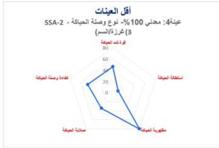
شكل (٨) معامل الجودة الكلية لأقل العينات (رقم ٤) بمساحة مثالية (٣٧٠٢.٤٦) ومعامل الجودة (٤٣.٥٢) بنوع خامة (١٠٠% معدني)، ونوع وصلة (SSA-2)، بكثافة (٣ غرز/السم).
